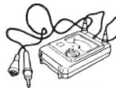
tester izolačného odporu (tester Megger)
